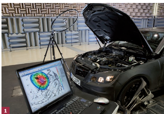
FOT. 1–2. Firma KFB Polska Sp. z o.o. do analizy poziomu hałasu stosuje specjalistyczny sprzęt w postaci kamer akustycznych; fot.: KFB Polska
